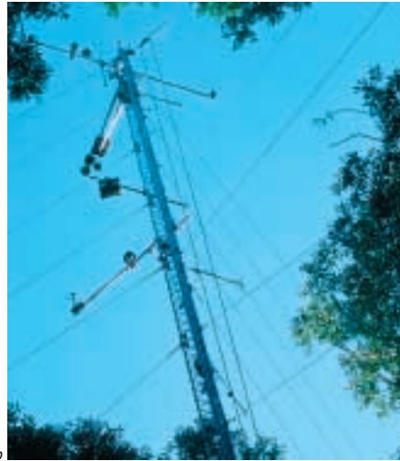
Abb. 2: Messmethoden zur Bestimmung des CO 2 -Austauschs zwischen Atmosphäre und Ökosystem. a) Messung des Stammumfangs, um über die Holzvorräte den Kohlenstoffgehalt zu ermitteln. b) Messturm mit Sensoren, die es erlauben, die CO 2 -Flüsse mit der Eddy-Kovarianz-Methode zu bestimmen.
